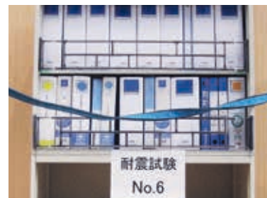
タフガード(ダブル) 耐震試験風景
