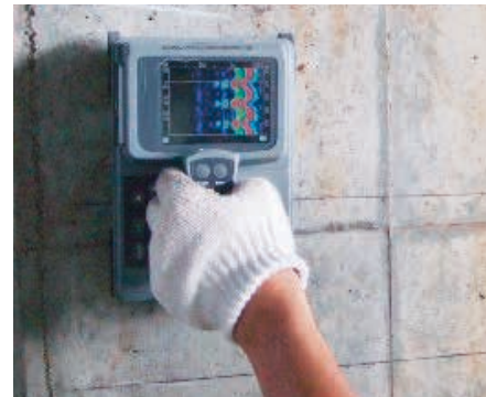
鉄筋探査状況
